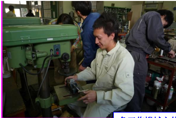
各工作機械を使用し、材料の切断や 穴あけ作業などを行います
