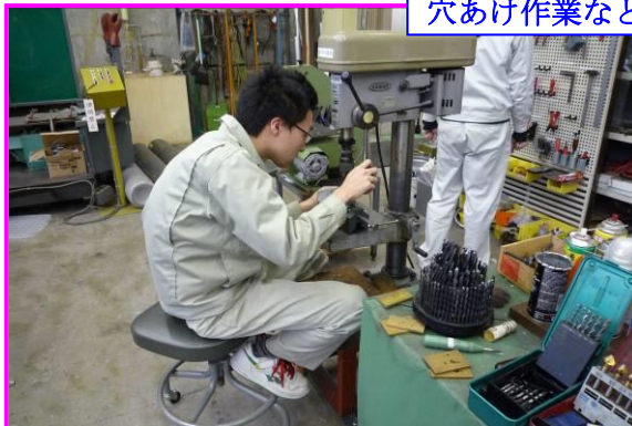
各工作機械を使用し、材料の切断や 穴あけ作業などを行います
