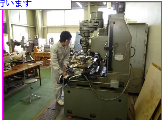
各工作機械を使用し、材料の切断や 穴あけ作業などを行います
